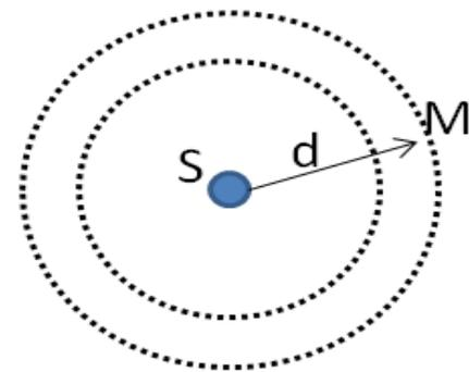
Pour une source isotrope (c'est-à-dire émettant la même énergie dans toutes les directions) de puissance  $P$ , l'intensité sonore  $I$  au point  $M$  dépend de la distance  $d$  à la source et s'exprime de la façon suivante :
