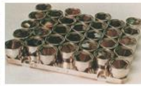
Apollo 14: 100 retro réflecteurs « coin de cube » de 38 mm sur un plan
